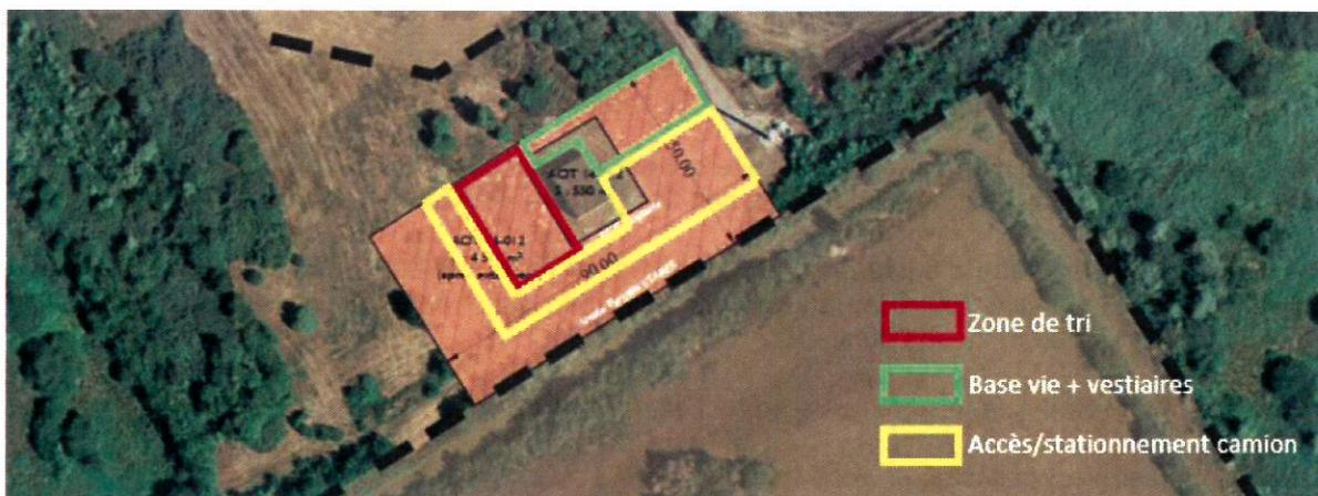
Figure 1 : emplacement des zones de chantier
