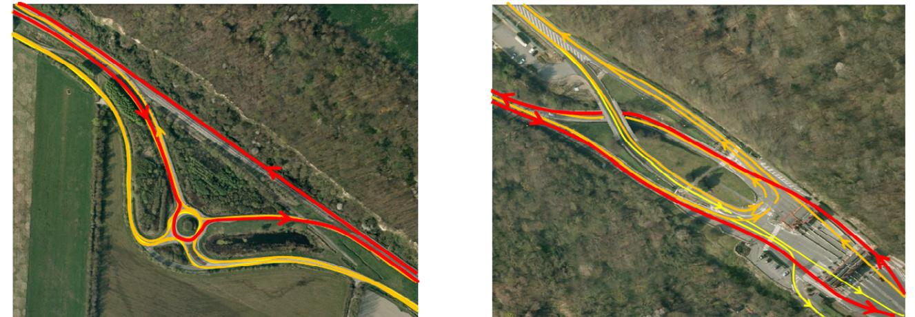
Figure 40 : Schéma des flux sur le giratoire nord et l'accès nord
