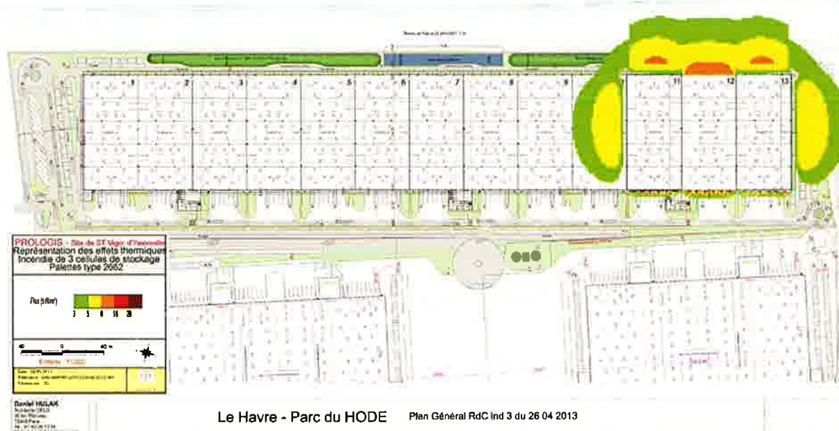
Figure 4 : Représentations graphiques des effets thermiques d'un incendie de 3 cellules contenant des palettes type 2662
