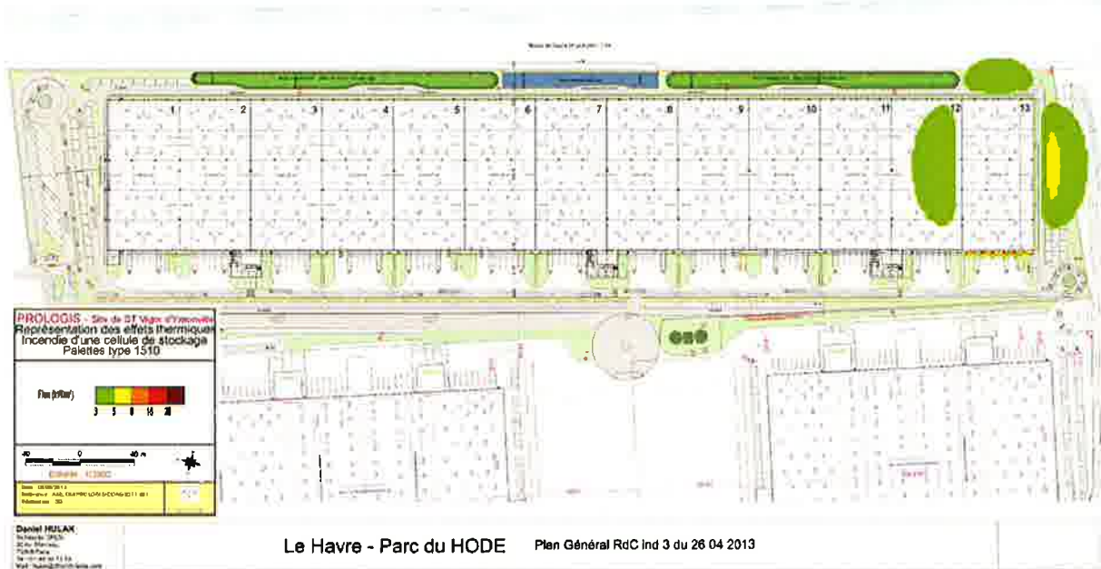
Figure 1 : Représentations graphiques des effets thermiques d'un incendie d'une cellule contenant des palettes type 1510
