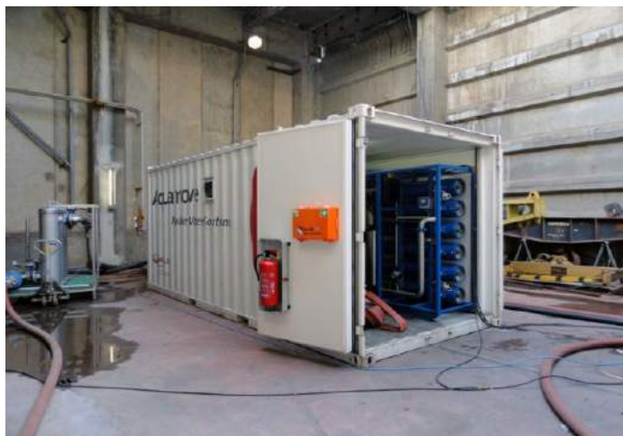
Figure 69 : Unité d'osmose inverse mobile
