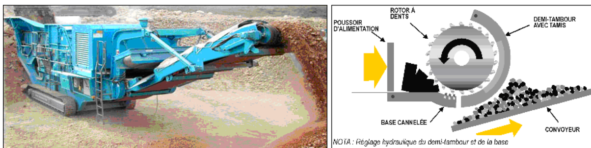
Figure 56 : Concasseur et principe du concassage
