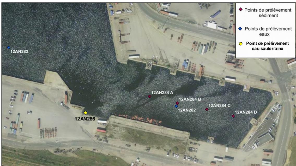
Figure 46 : Localisation des prélèvements d'eau de surface, d'eau souterraine et de sédiments (INERIS 2012)
