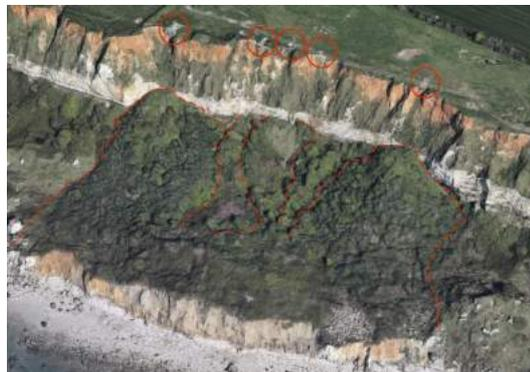
Plateformes et de cônes de décharge.
